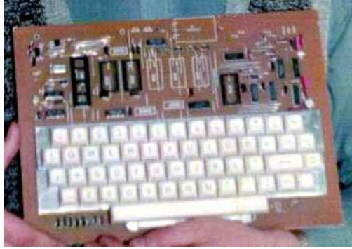
Kučni računar Galaksija u fazi montaže delova
